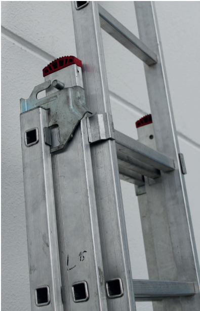
Abb. 37: Kombinationsleiter, Kopfende und Sicherungsbügel
