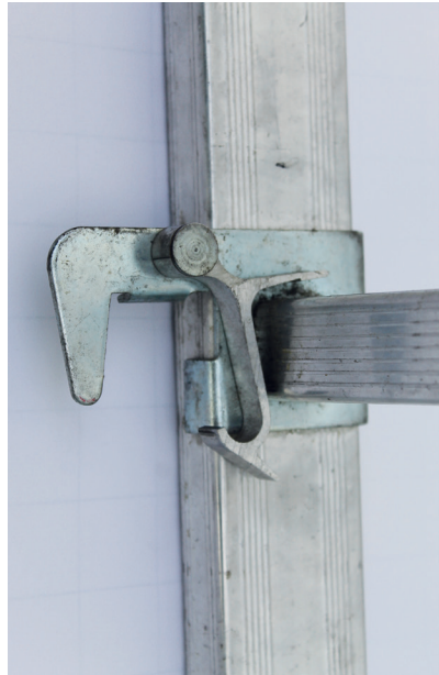
Abb. 37: Kombinationsleiter, Kopfende und Sicherungsbügel
